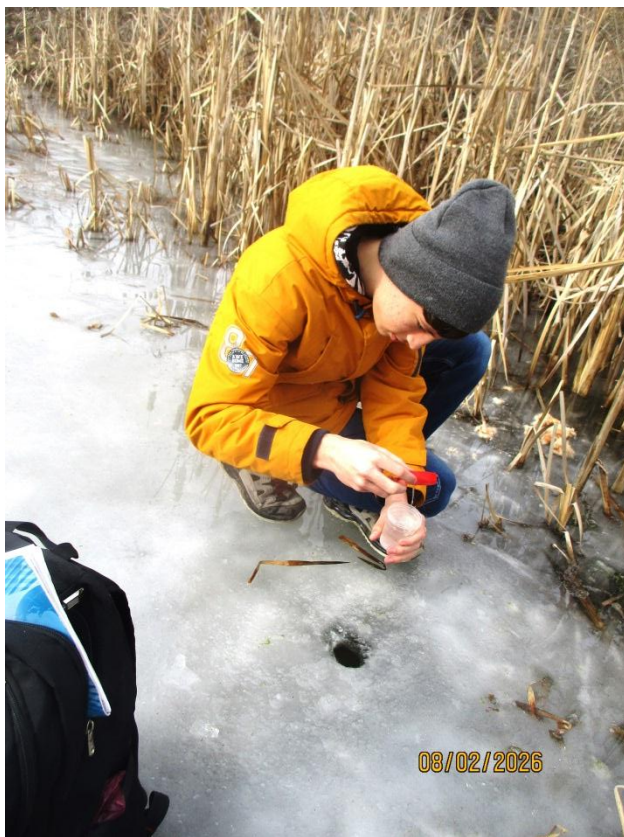
Рис.7. Отбор проб воды из Верхне-Дачного пруда, образованного дождевыми и бытовыми стоками дач. Проба отобрана в лунке с толщиной льда 5см.
