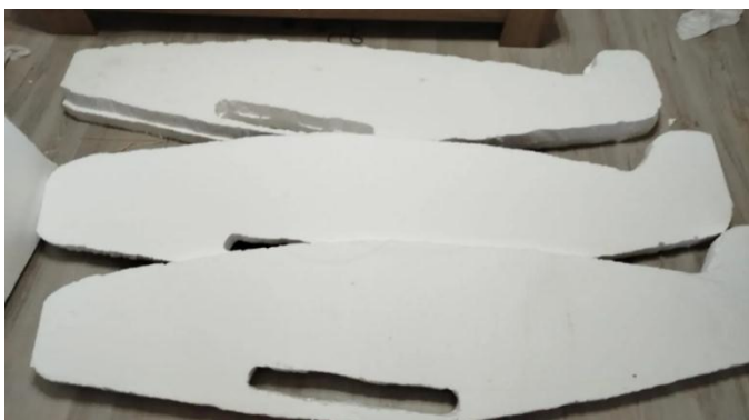
(рис.3) Из пенопласта вырезаем основу и крылья для самолёта.
